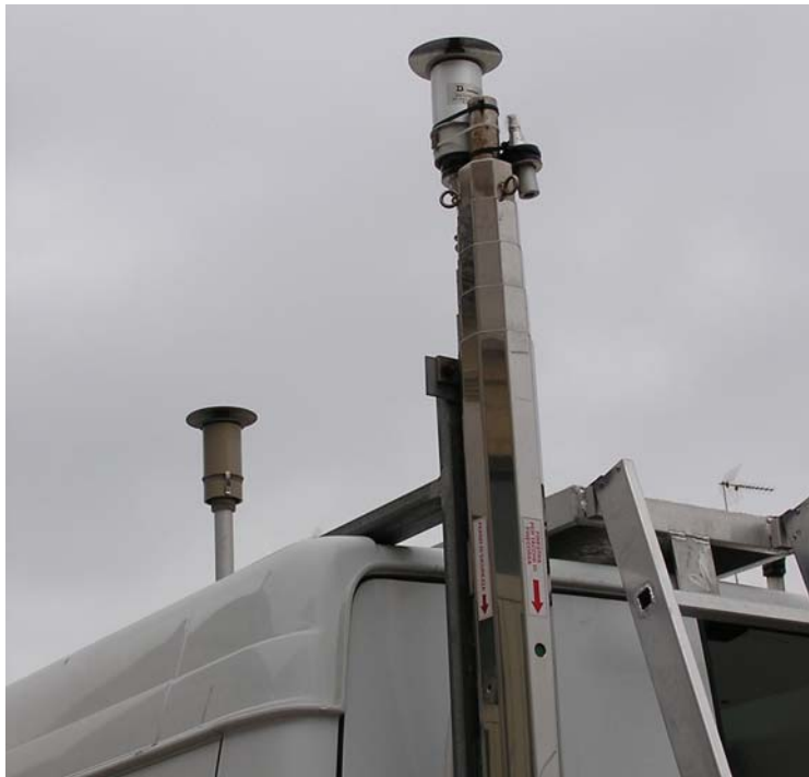
Fig. 2 – Teste di campionamento del particolato PM10 e PM2.5 (Ottobre 2005)
