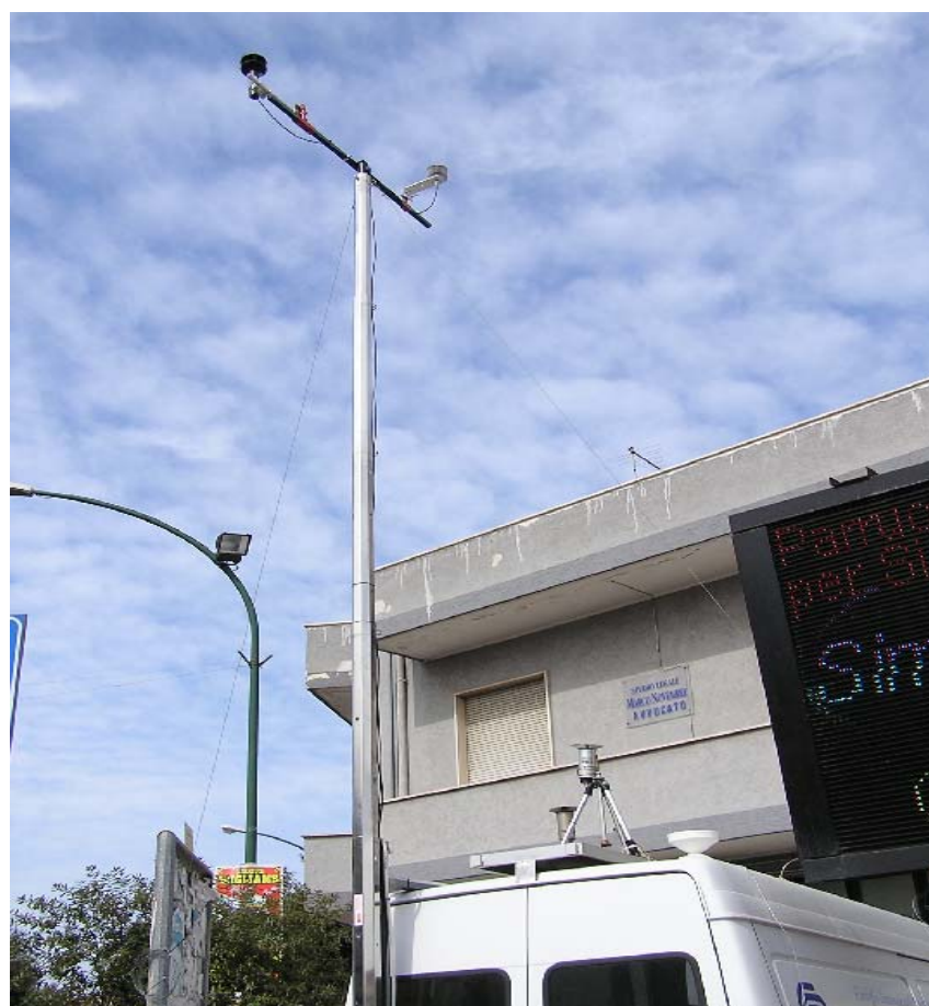
Fig. 3 – Anemometro e termoiigrometro e teste di campionamento (Marzo 2006).
