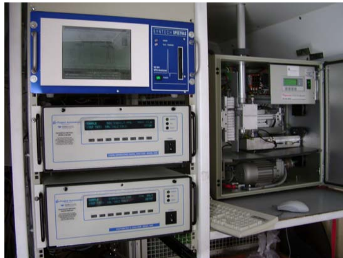
Fig. 2 – In senso antiorario: campionatore sequenziale di particolato PM10, analizzatore di Benzene, Toluene e Xilene, analizzatore automatico di ossidi di azoto e analizzatore automatico di ozono.
