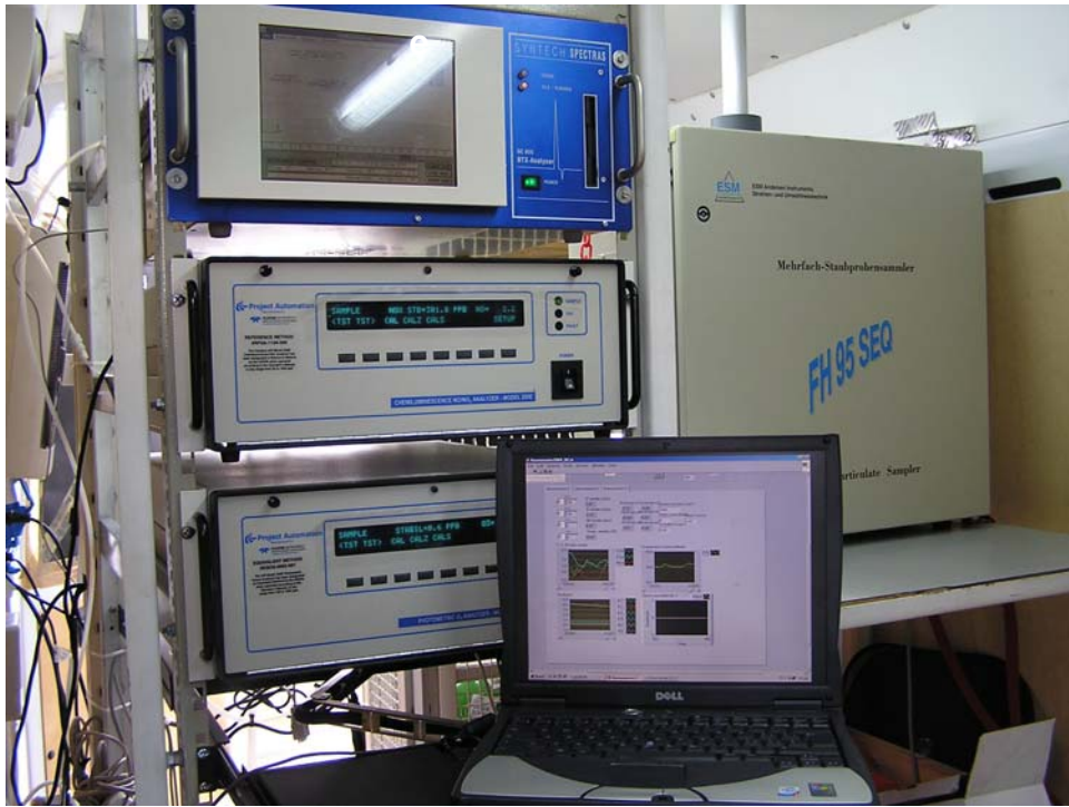
Fig. 4 – In senso antiorario: campionatore sequenziale di particolato PM10, analizzatore di Benzene, Toluene e Xilene, analizzatore automatico di ossidi di azoto e analizzatore automatico di ozono.
