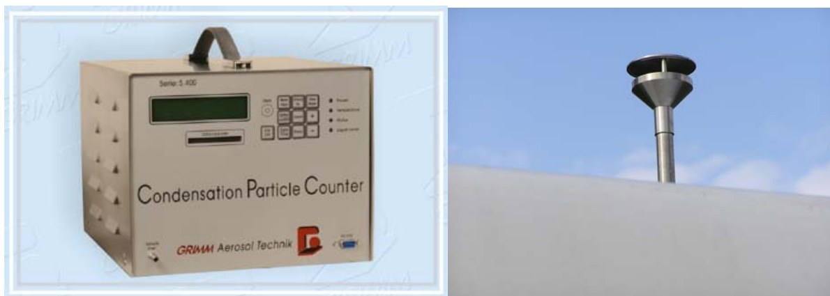
Fig. 6 – Contatore di particelle ultrafini e la sonda di aspirazione, utilizzati per la misura della concentrazione numerica delle particelle atmosferiche dal tetto del Laboratorio Mobile.
