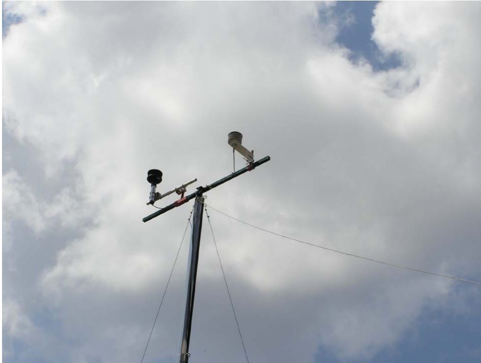
Fig. 3 – Anemometro e termoigrometro (Luglio 2006).
