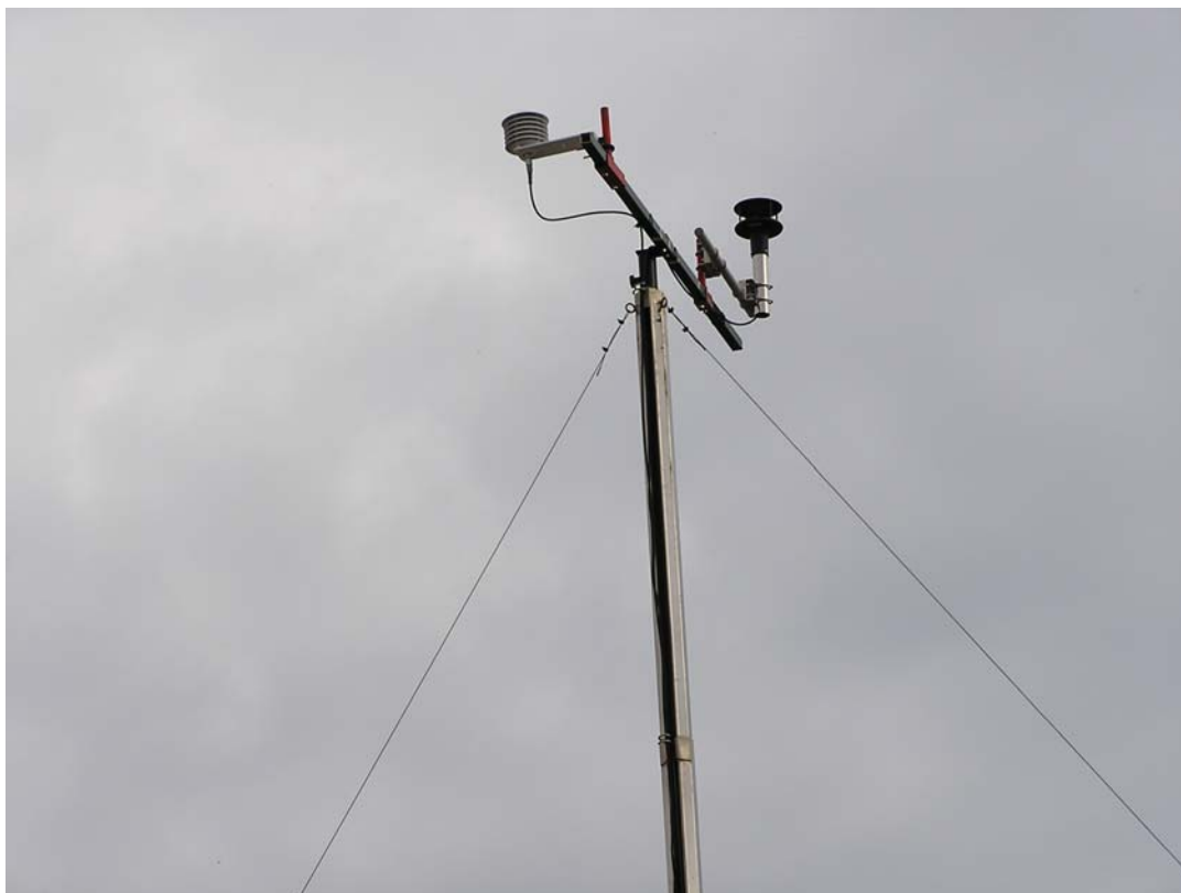
Fig. 2 –Anemometro e sonda per la temperatura e l'umidità dell'aria (Dicembre 2005)
